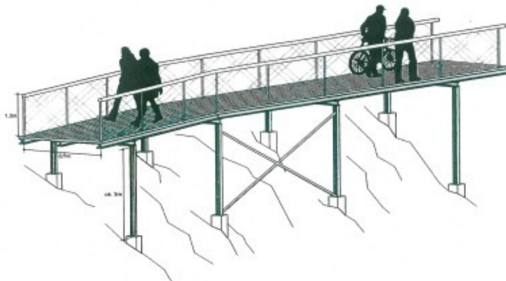
Rysunek 8: Propozycja lekkich kładek stokowych (źródło: firma ARUP).
