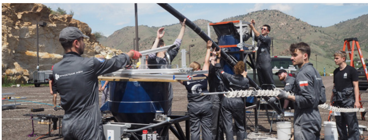
TOLRECON - przenośnik regolitu księżycowego
